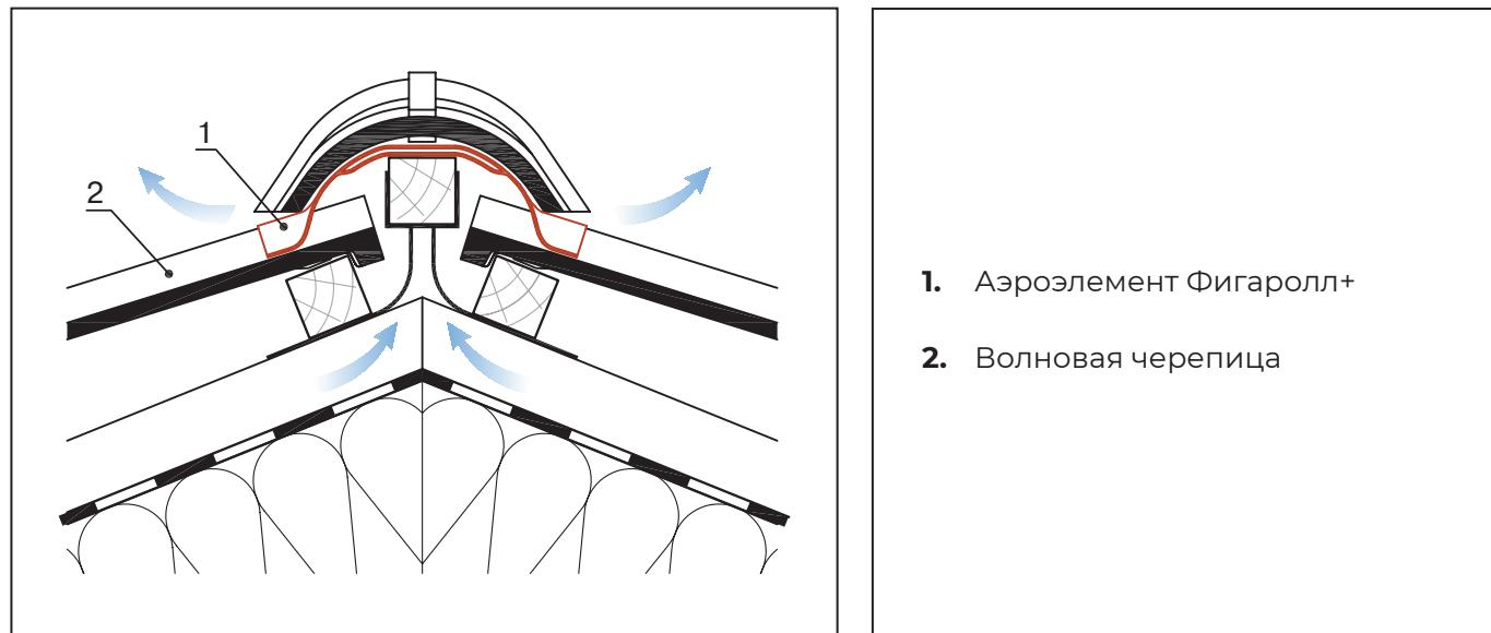
1. Аэроэлемент Фигаролл+
