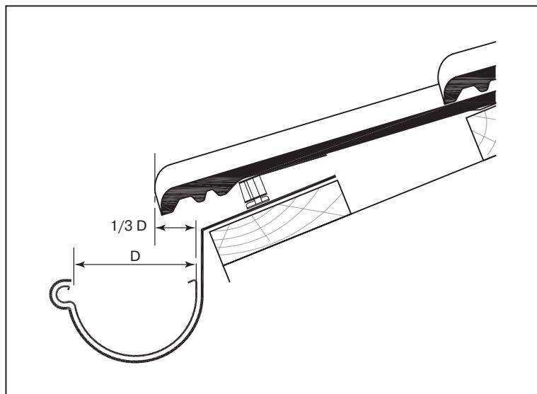
При наличии водосточного желоба значение PUT определяется в пределах минимального и максимального значений, указанных в таблицах 5.1 и 5.2, и не должно превышать  $1/3$  диаметра желоба.
