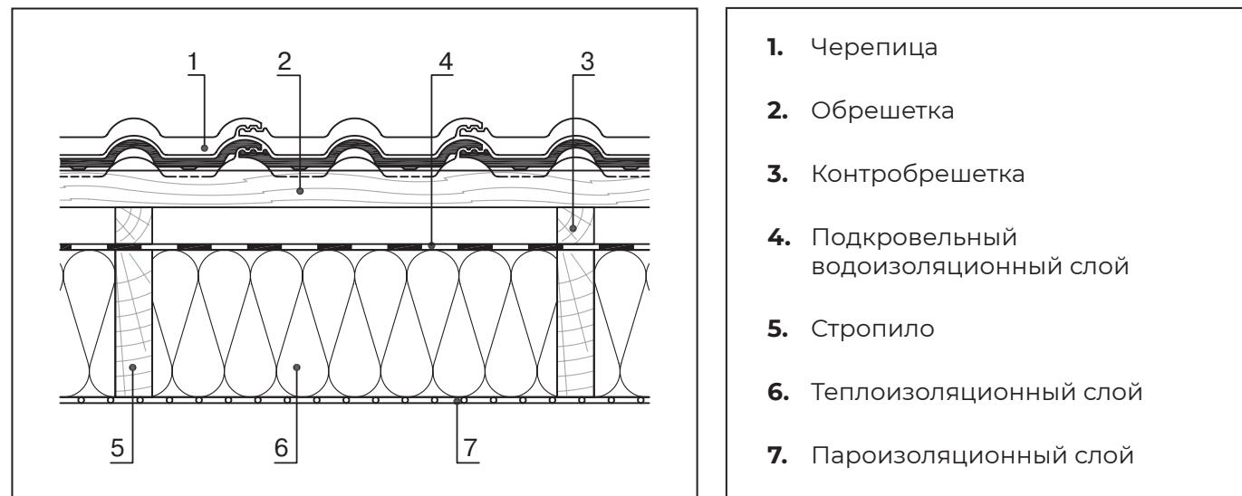
В качестве пароизоляционного слоя применяются пароизоляционные пленки BRAAS или BRAAS PRO.
