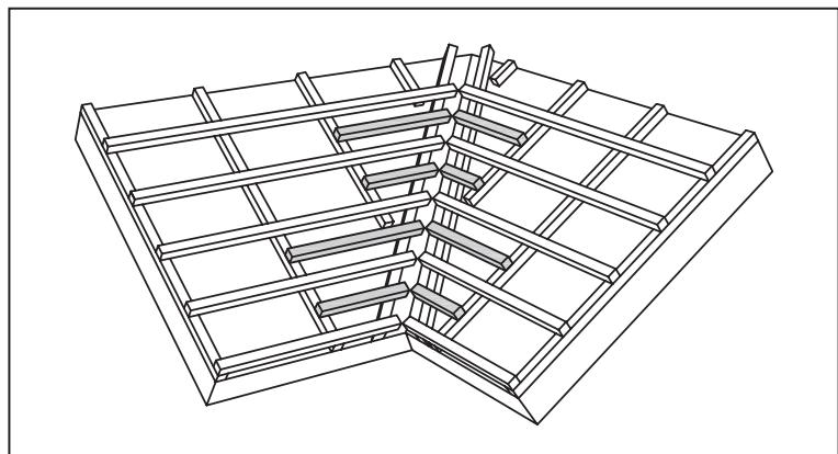
В ендове устанавливаются дополнительные бруски между шаговой обрешеткой, которые опираются на диагональную и шаговую контробрешетку. Учащенная обрешетка служит основанием для желобка ендовы и обеспечивает вывод воздушного потока из подкровельного пространства.
