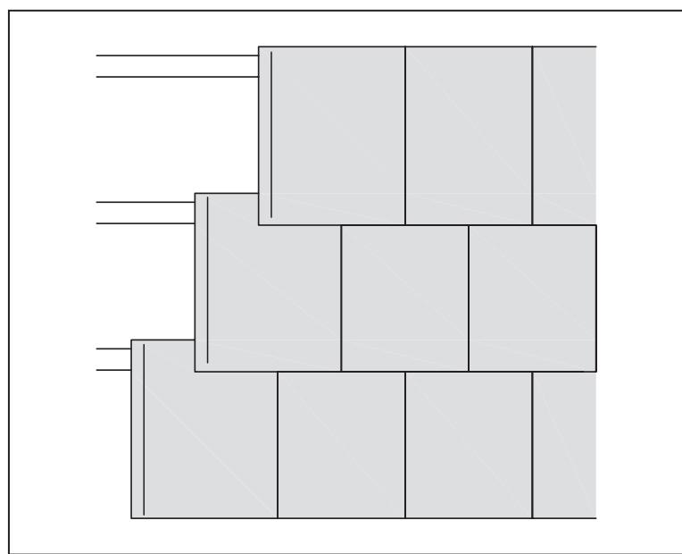
Производится со смещением черепиц в смежных горизонтальных рядах на половину ширины черепицы. Применяется для плоской черепицы.
