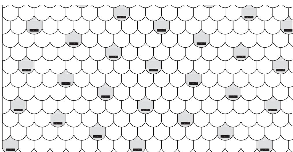
**Таблица 3 – Выбор схемы расстановки снегозадерживающих скоб в зависимости от расчетного количества, для черепицы Опал, шт/кв.м**
