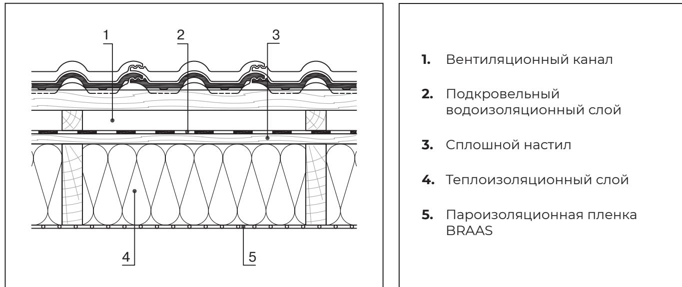
Рисунок 3.7 – Кровля со сплошным настилом, с утеплением, с двумя вентиляционными каналами
