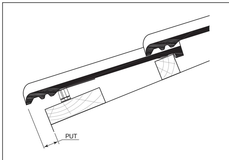
При отсутствии водосточного желоба значение PUT определяется в пределах минимального и максимального значений, указанных в таблицах 5.1 и 5.2.
