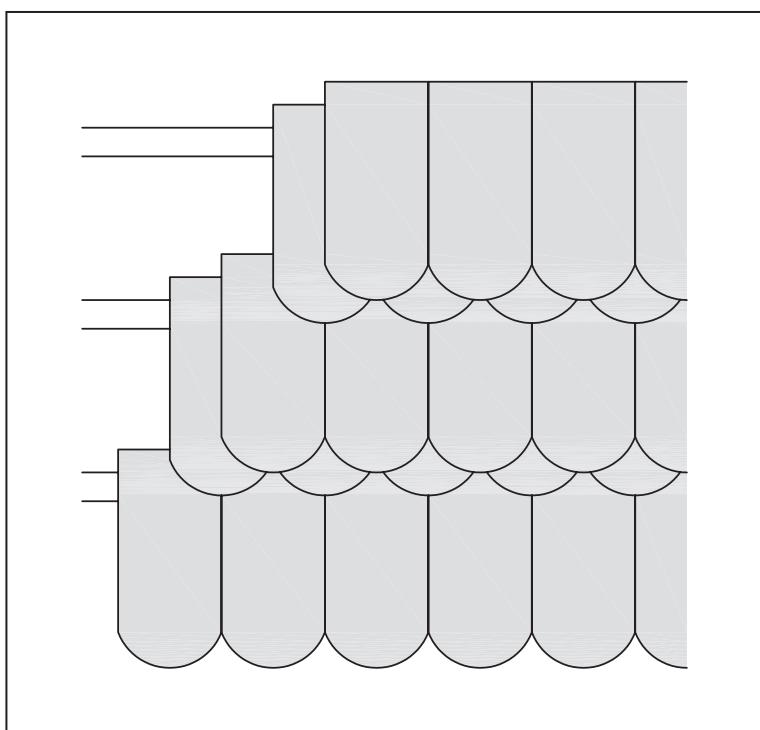
**Двойная укладка венцом:** на каждом брусье обрешетки выкладывается по два ряда черепицы со смещением каждой черепицы на половину ширины.
