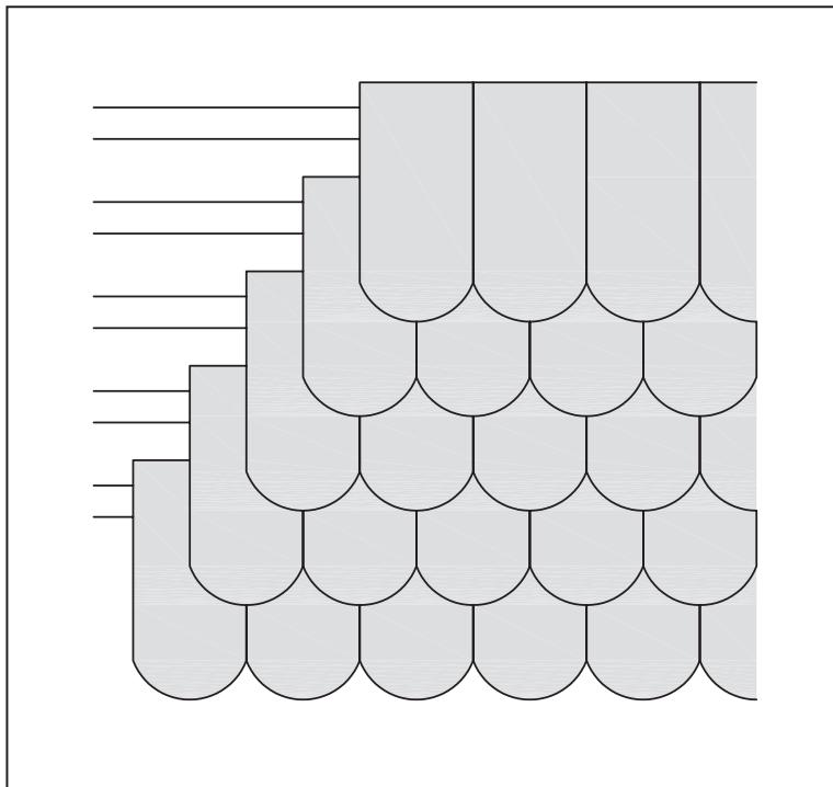
**Двойная укладка вперевязку:** на каждом брусье обрешетки выкладывается по одному ряду черепицы со смещением на половину ширины черепицы нижерасположенного ряда.
