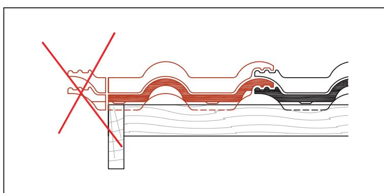
Подрезка рядовой черепицы на фронтонном свесе для подгонки ширины кровельного покрытия не допускается.
