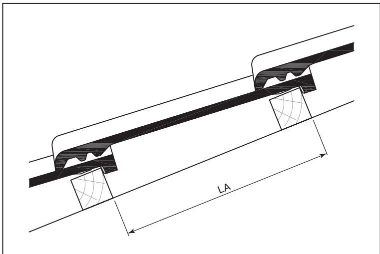
Расчет значения LA осуществляется, в соответствии с расчетной схемой на рисунке 5.1, последовательно в 3 этапа.
