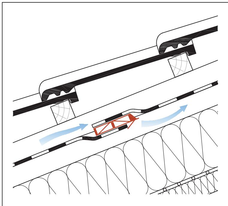
Применяется в конструкциях кровель с двумя вентиляционными каналами, при рекомендуемых и малых уклонах, для соединения верхнего и нижнего вентиляционных каналов.
