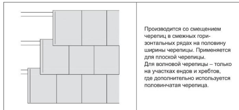
Рисунок 13.2 – Простая укладка вперевязку
